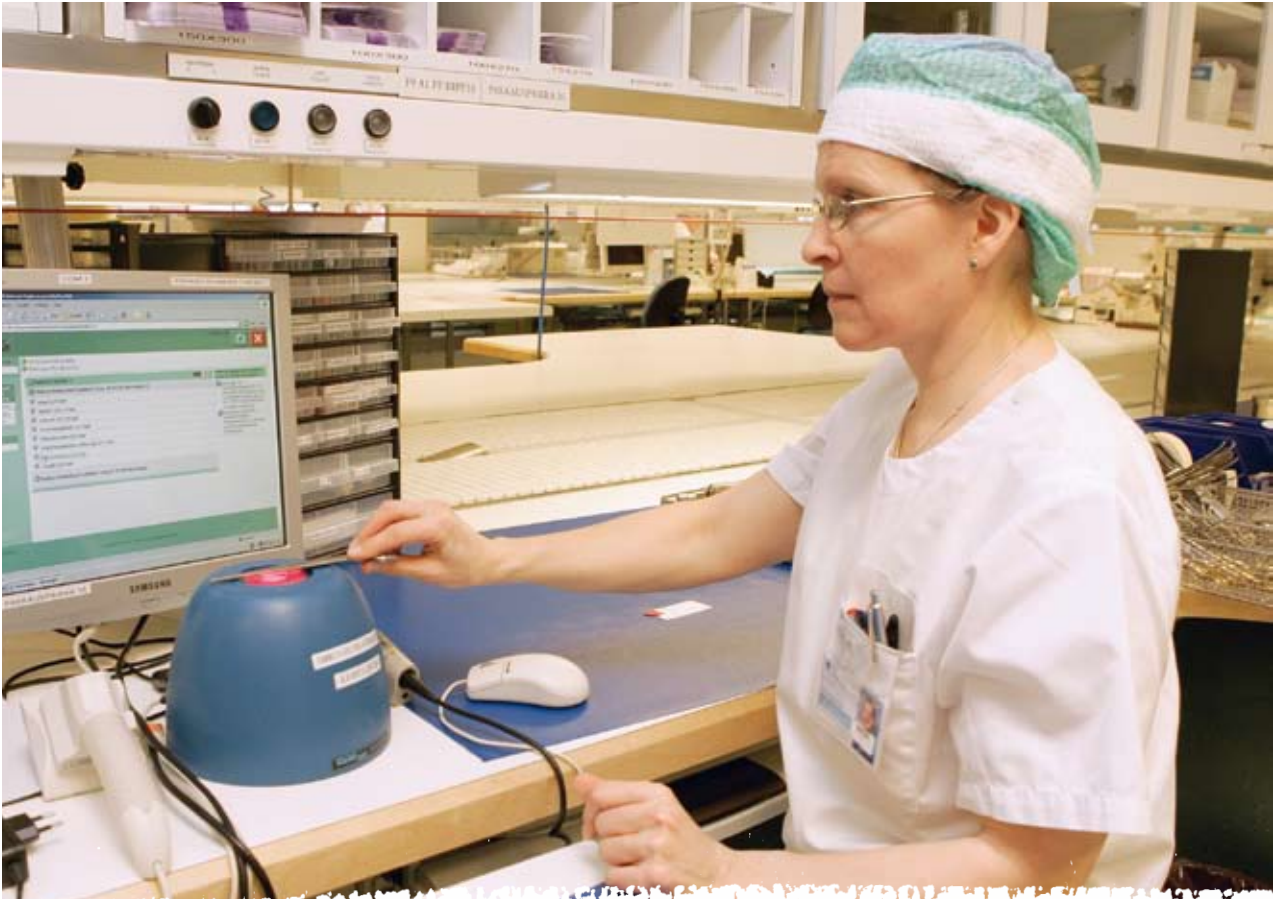
Meilahden sairaalan leikkausosastolla instrumenttien kulkua seurataan nyt sähköisesti, koodeilla ja älykameralla. Salme Salo pakkaa instrumentteja laitteen avulla.
